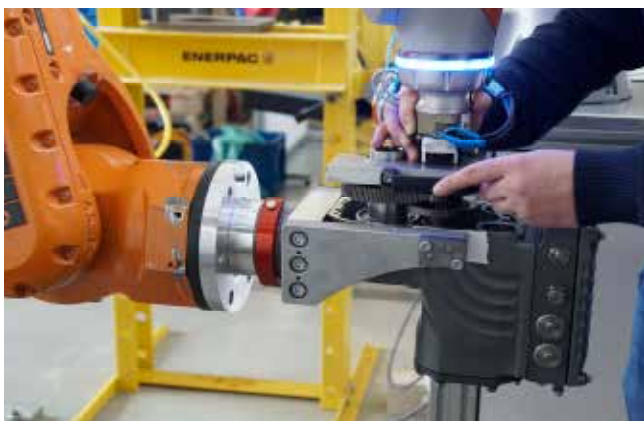
Zerlegung eines Getriebes mithilfe von MRK
