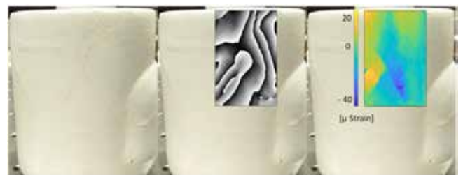
Rissbehaftete Keramik, links: Angedeuteter Rissverlauf, nahezu unsichtbar, Mitte: Shearografisch ermitteltes Differenzphasenbild, rechts: Dehnungsmessergebnis
