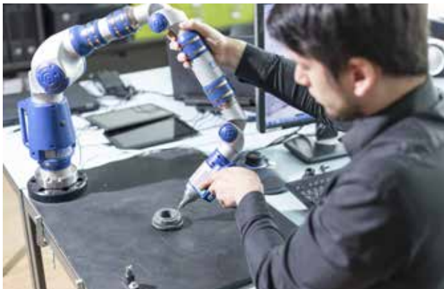
Desktop-Digitalisierungssystem (Reverse Engineering)
