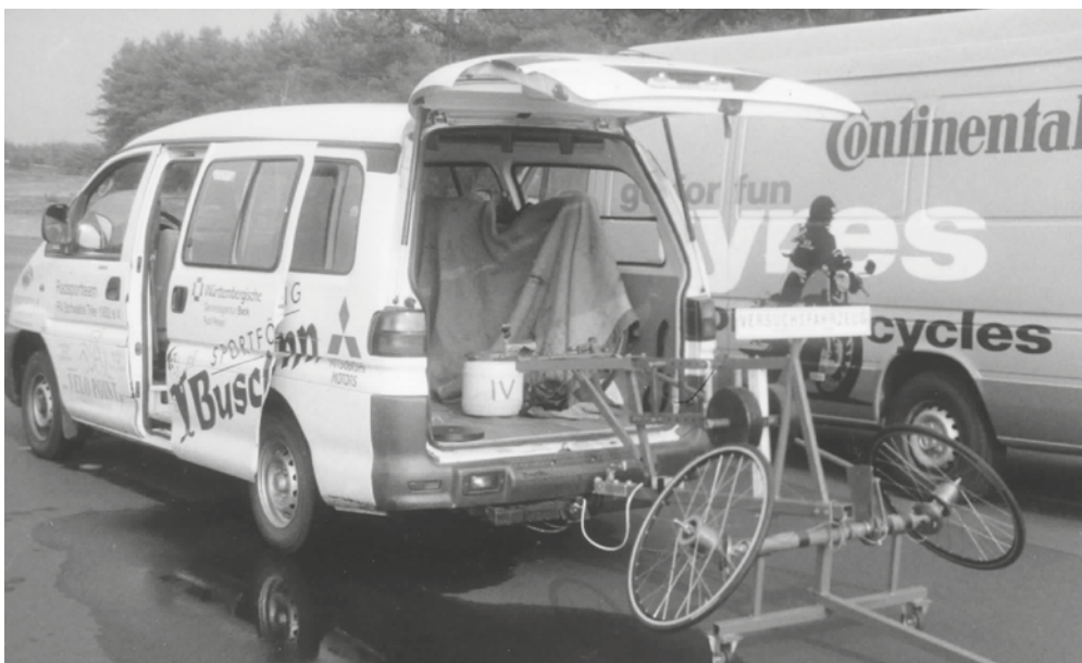
Straßenprüffahrzeug für das Kurvenverhalten von Fahrradreifen
